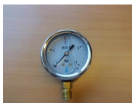
MANOMETRE BAIN D'HUILE 0-4 BARS – R1/4" VERTICAL
