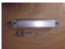
VERIN PNEUMATIQUE D63 – C300 AVEC ARTICULATION 266-010
