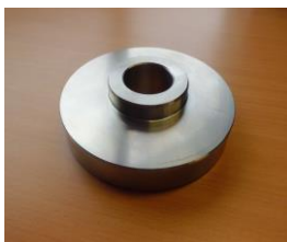
ENTRETOISE EN INOX Ø 110/30 INTERIEURE POUR RESSORT LARGEUR 75 mm
